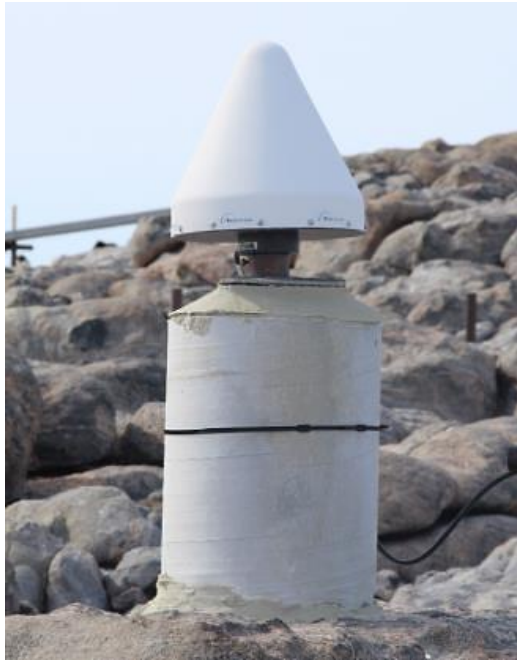
Balise GPS géodésie (topographie-topométrie)
