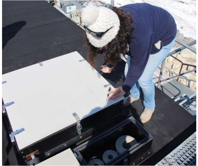
Les trappes des instruments sur le toit du shelter (trappe du télescope et trappe pour l'émission laser)
